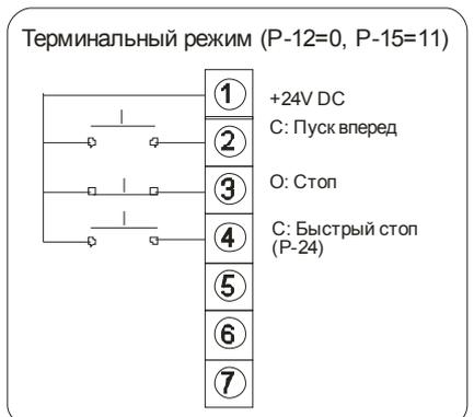
Управление кнопками без фиксации с использованием быстрого останова
