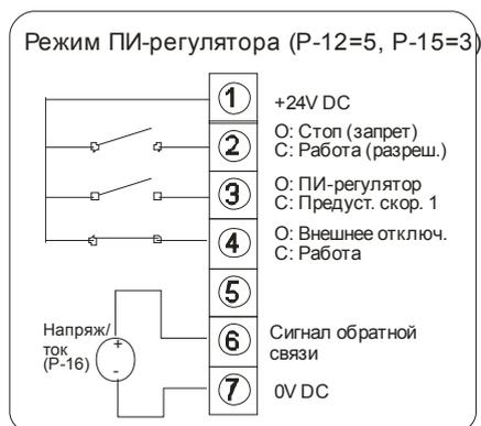
Режим ПИ-регулирования, предуст. скорость 1 и термистор двигателя
